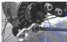
Afbeelding 1: Rohloff SPEEDHUB 500/14 met snubber
