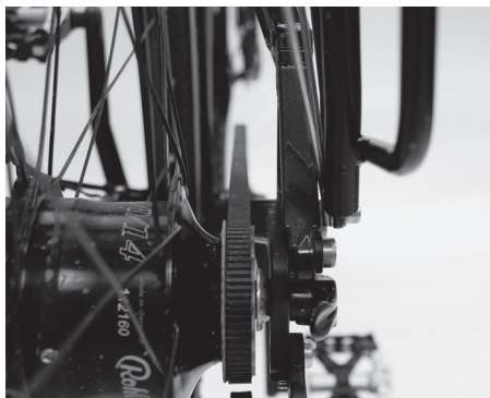
Afbeelding 3: correcte uitlijning van de riem
