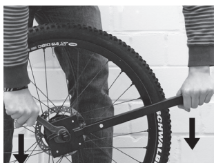
Afbeelding 5: vastzetten van de achterste tandriemschijf met de tandriemschijfsleutel en een steeksleutel M24 voor het tegenhouden van de Rohloff tandkransafnemer
