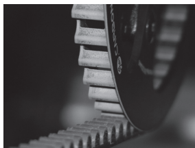
Afbeelding 2: afslijten van de productietechnisch noodzakelijke blauwe laagt
