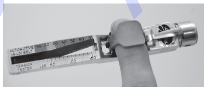
Fixeren van de Tension Tester (art.nr. 10400009)
